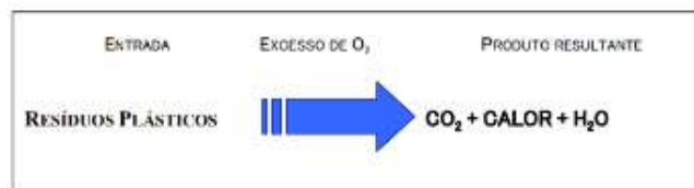
Figura 1. Esquema do processo químico da reciclagem energética - Fonte: Zenin e Mandici (2004) e informações no site www.plasticos.com.br .
